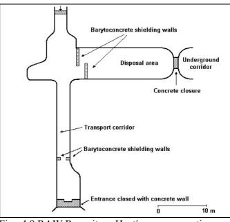
Fig. 4.9 RAW Repository Hostím – cross section
